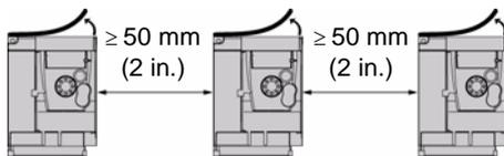
Espace libre  $\geq 50$  mm (2 in.) de chaque côté. Le cache de l'orifice de ventilation doit être retiré pour un fonctionnement avec une température de l'air ambiant supérieure à  $50^\circ\text{C}$  ( $122^\circ\text{F}$ ). Le degré de protection devient IP20.
