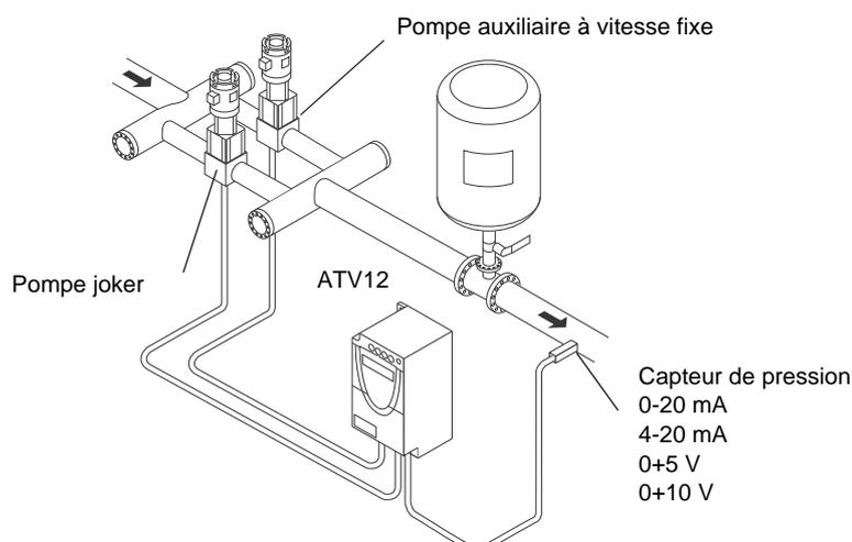
La commande de la pompe auxiliaire est effectuée par l'Altivar 12 via la sortie logique LO.
