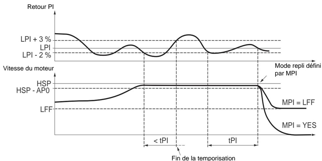
Lorsque la vitesse de la pompe joker est à son maximum (supérieure à HSP - APO) et que dans le même temps le retour PI est inférieur au seuil de supervision LPI - 2 %, une temporisation tPI est lancée. Si au terme de cette temporisation la valeur du retour PI reste inférieure au seuil de supervision LPI + 3 %, alors le variateur passe en mode de repli défini par le paramètre MPI.
