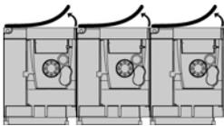
Variateurs montés en côte à côte, le cache de l'orifice de ventilation doit être retiré (le degré de protection devient IP20).
